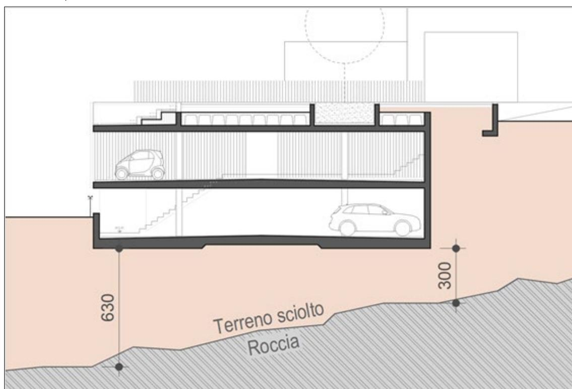
**Fig. 5:** Sezione stratigrafia terreno
