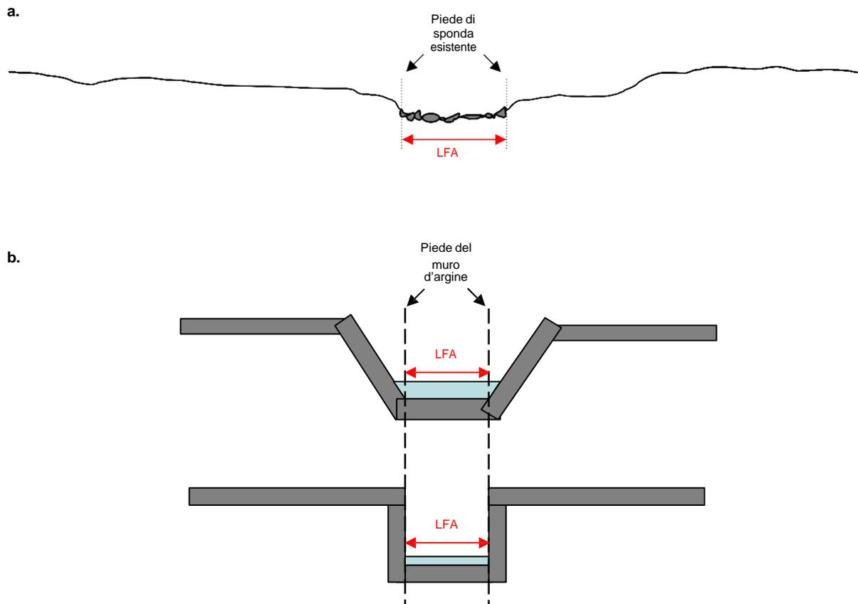
**Figura 2: Definizione della larghezza del fondo dell’alveo per corsi d’acqua temporanei (a.) e per corsi d’acqua arginati (b.).**
